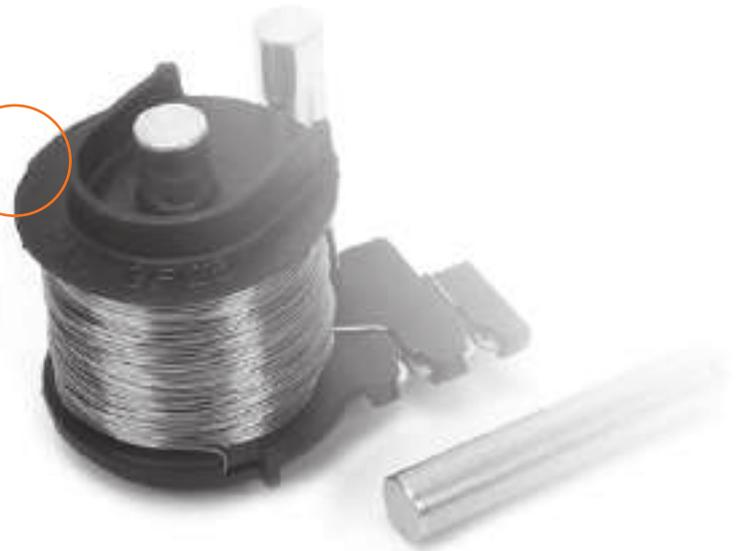
Die Besonderheit der magnetisch halbharten Werkstoffe der VACUUMSCHMELZE liegt in der guten Duktilität. Im Gegensatz zu den spröden Seltenerd-Dauermagneten und den Al-NiCo-Legierungen können CROVAC und VACOZET kaltverformt und damit auch in Form von Draht und Stangen geliefert werden. Auch lassen sich Teile gut biegen und bearbeiten.
