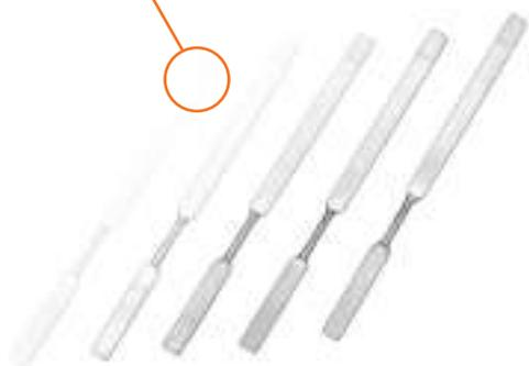
Zunehmende Anforderungen an die Präzision, Zuverlässigkeit und Qualität von Glas-Metall und Keramik-Metall-Verbindungen sowie reproduzierbare hohe oder niedrige thermische Ausdehnung können durch den Einsatz von VACOVIT oder VACON gelöst werden. Diese Legierungen zeichnen sich durch eine kontrollierte Wärmeausdehnung mit linearen Ausdehnungskoeffizienten von sehr kleinen Werten bis ca.  $12 \cdot 10^{-6} \text{ K}^{-1}$  aus.
